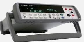
用于校准设备的放电电流和放电电压，恒流放电主要作用在设置恒流放电时的电流校准；放电电压的校准主要作用在设备运行过程中对电池电压的采集精准度上 (PS: 恒流源可使用电池代替)
